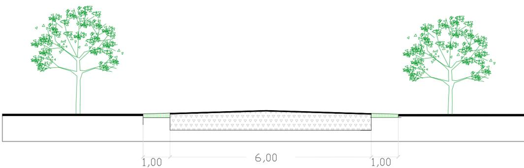
**CORTE TRANSVERSAL DO PAVIMENTO ASFALTICO**
